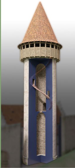
Schnitt durch den rekonstruierten Bergfried mit Visualisierung der inwändigen Treppenhelix zum Obergeschoss. Bearbeiter: Archimedix GmbH
